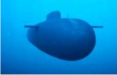
وقد صمم الروبوت ليعمل بشكل مستقل لمدة ستة أشهر تقريباً. ويمكنه أن يطفو بصورة دورية على السطح، وينقل المعلومات المجمععة إلى قمر صناعي، أو جهاز إعادة الإرسال. ويعتبر هذا الروبوت مثالياً للعمل في البحيرات والأنهار ذات التيارات الهادئة.
